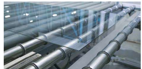
Detección de láminas de vidrio sobre transportador
