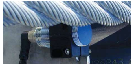
Control de distancia para control de posición
