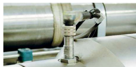
Control de cilindro hidráulico con sensores
